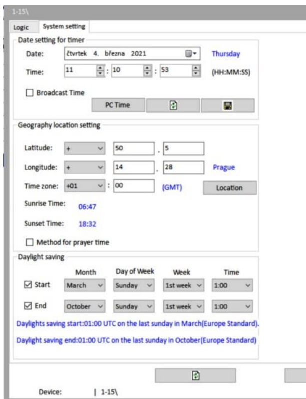
Obr. 4 HDL Buspro: Nastavení vlastností logického modulu
